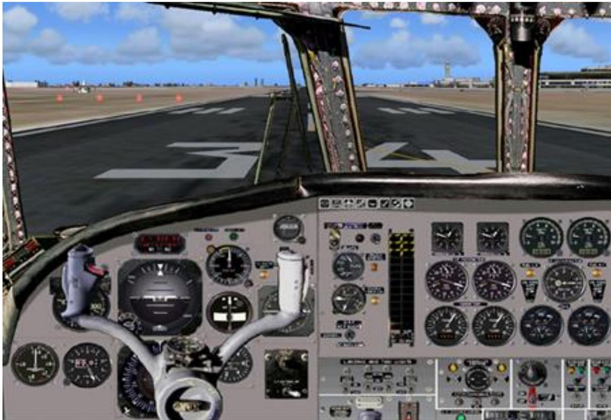
Il pannello principale è composto di tre parti: gli strumenti per il pilota sulla sinistra, gli strumenti per i motori sulla destra e alcuni strumenti sulla consolle centrale nella parte inferiore destra.
