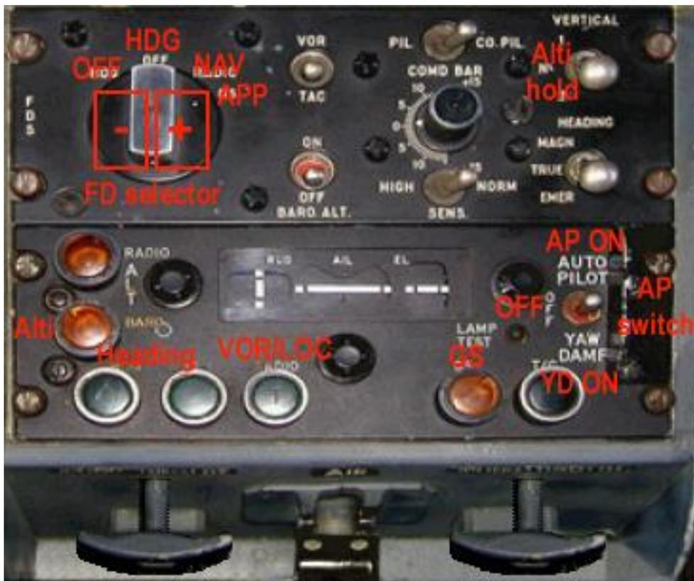
Il selettore del Flight Director è l'interruttore FD; Cliccate sulla parte destra del selettore per farlo ruotare a destra, e sulla sinistra per farlo ruotare a sinistra. Da sinistra a destra le funzioni sono marcate nel modo seguente:
